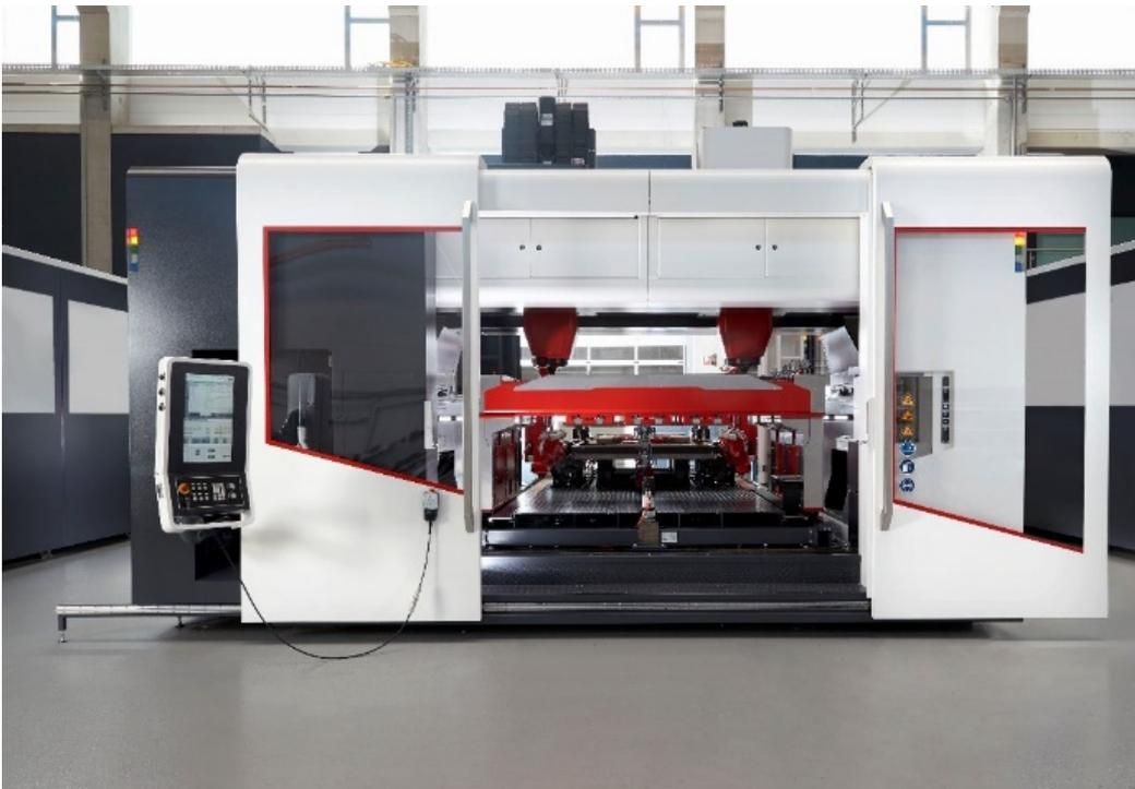
*Die Doppelspindel-FSW-Portalmaschine D-DSM von Grenzebach ermöglicht mit ihren zwei unabhängig operierenden Schweißköpfen noch schnelleres und effizienteres Arbeiten.*
