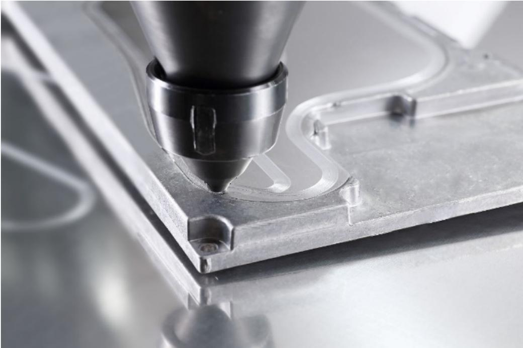
*Beim Rührreibschweißen werden die Werkstücke durch Reibung, Druck und Wärme miteinander verbunden. Es entsteht eine beständige, medien- und druckdichte Schweißnaht.*
