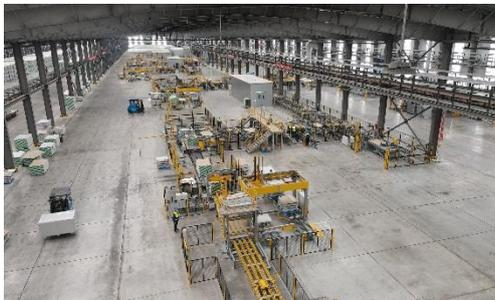
Jede Gipskartonplatten-Linie ist mit zwei hochmodernen Verpackungslinien sowie einer Streifenschneid-Einrichtung (Dunnage-Maschine) mit ausreichender Leistung für alle Verpackungslinien ausgestattet.
