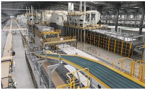
Für die Verarbeitung von synthetischem Gips entstanden zwei Produktionslinien. XINFA gehört damit zu den weltweit größten Produktionsstätten für Gipskartonplatten.
