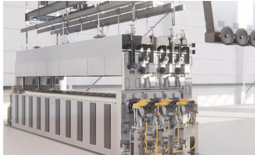
Wenn das Glas aus dem Zinnbad gehoben wird: die Drossbox. Verbesserte Glasqualität durch homogenere Temperaturverteilung über die gesamte Breite des Glases.
