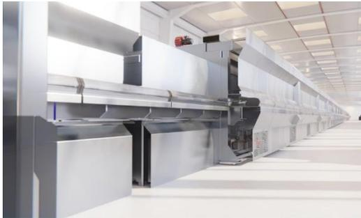
Mit der neuen Generation an Rollenkühlofen erhöht Grenzebach nun die Flexibilität am Annealing Point und eröffnet Kunden neue Möglichkeiten zur Erzielung der perfekten Glasspannung für verschiedenste Produktionsszenarien.
