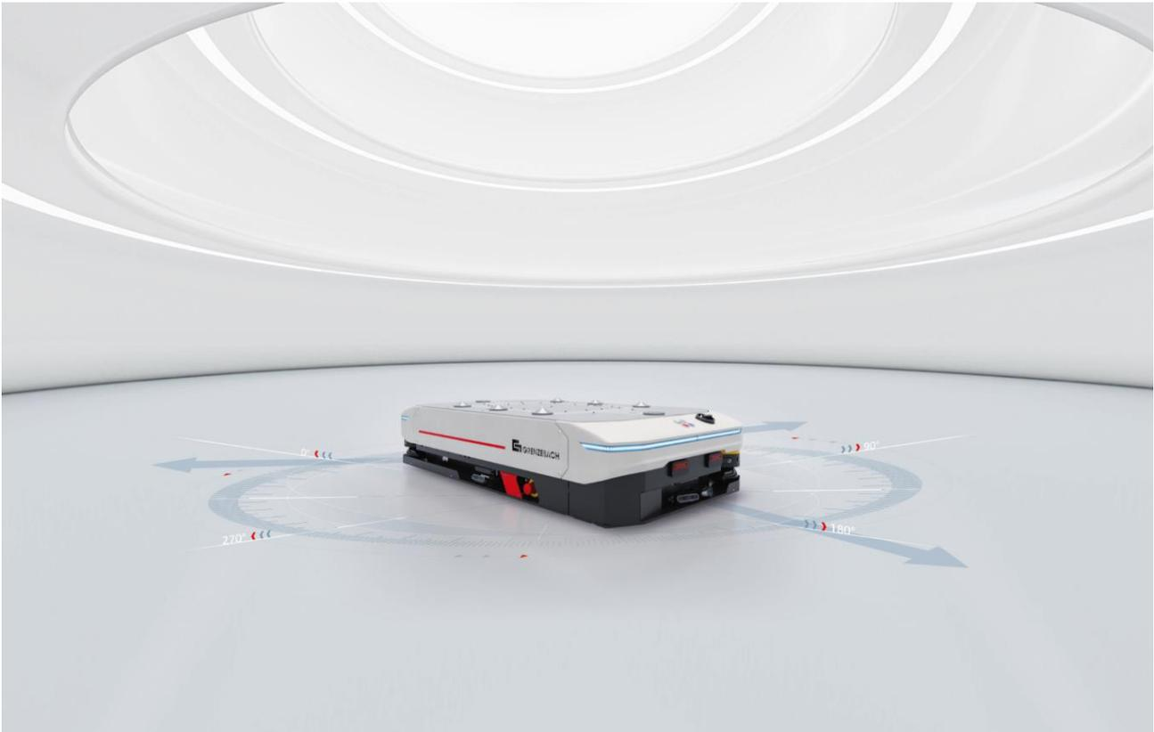
*360° Vorsprung: Das fahrerlose Transportfahrzeug OL1200S von Grenzbach macht mit seinem omnidirektionalen Antrieb und einem innovativen Technologiepaket speziell den Transport langer Warenträger einfacher, schneller und sicherer.*
