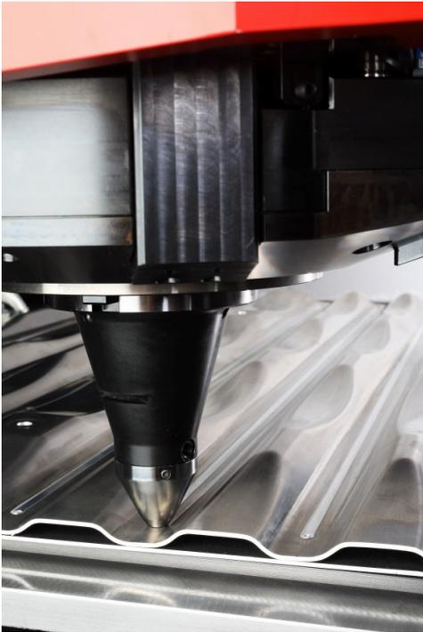
*Beim Rührreißschweißen erzeugt ein drehender Reibstift durch Reibung und Druck an der Nahtstelle die benötigte Prozesswärme. Der Werkstoff wird durch die eingebrachte Wärme plastisch verformbar und durch die Rotation des Werkzeugs entlang der Nahtstelle verrührt.*
