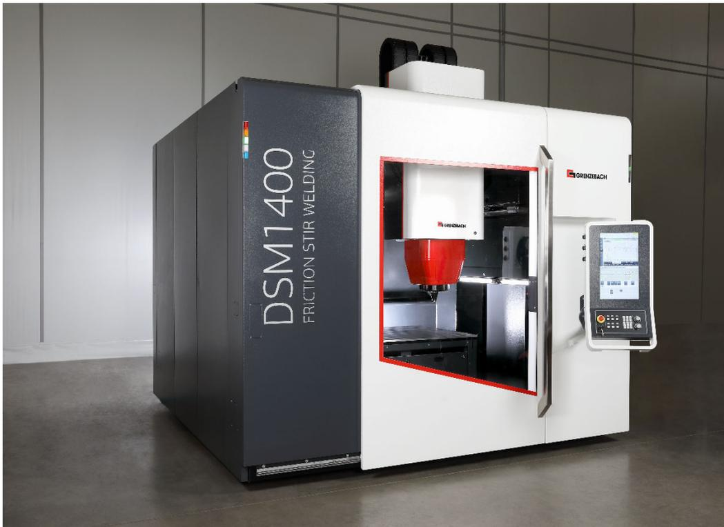
Die kompakten 4-Achs-Portalmaschinen der DSM-Serie (DSM = Dynamic Stirring Machine) stehen für eine hohe Achsdynamik, präzise Bahnführung sowie intuitives Steuerungs- und Bedienkonzept.
