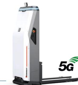
Das FF1200S transportiert Paletten mit einer Nutzlast von bis zu 1.200 kg. Dank des modularen Aufbaus kann es für unterschiedliche Anwendungsbereiche eingesetzt werden (Floor-to-Floor, Floor-to-Conveyor usw..).
