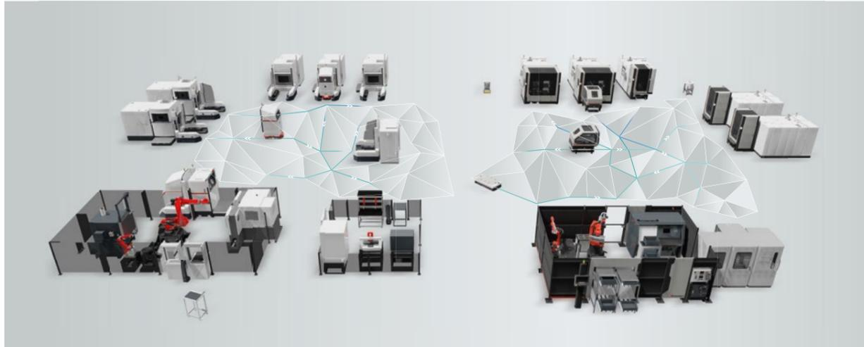
Grenzebachs Automatisierungstechnologien vernetzen Anlagen wie 3D-Drucker, Entpulverungs- oder Nachbearbeitungssysteme mechanisch, elektrisch und digital. Dabei werden Ihre Prozessschritte so intelligent verkettet, dass Ihre Systeme effizient ausgelastet werden, ein sicheres Arbeitsumfeld geschaffen und ein optimaler Fertigungsfluss erreicht wird. Fehlen in der Prozesskette Lösungen, können wir diese für Sie entwickeln.
