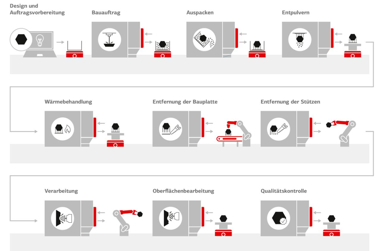
Dank den jüngsten Entwicklungen im Bereich der künstlichen Intelligenz sowie der Hard- und Software ist es heutzutage möglich, fast jeden Schritt der Prozesskette intelligent zu automatisieren. Gerade im Post-Processing werden im Vergleich zur Vorbereitungs- und Druckphase jedoch noch viele Bearbeitungsschritte manuell durchgeführt.
