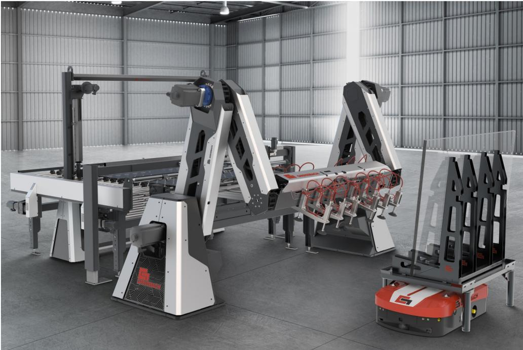
Ein starkes Team: Scheibenspeicher, Förderstrecke, Fahrerloses Transportsystemen (FTS) und der Tin-Air-Speed-Stacker TASS von Grenzbach. Mit dem TASS Schnellstapler hat das Unternehmen die Palette der Glas-Handlingsprodukte mit einer leistungsstarken Neuentwicklung erweitert. Durch die neuartige Doppelarm-Kinematik, verbunden mit einer ideal abgestimmten Zuführstrecke mit Scheibenspeicher, ist eine höchst effiziente, schnelle und flexible Stapelzelle für Glas-Kleinformat bis 2 Meter entstanden.
