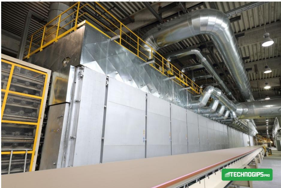
Unkompliziert zu erweitern: Der Cross-Flow Jet Trockner ist modular aufgebaut, so ließen sich einfach weitere Sektionen ergänzen – und somit die Kapazität steigern.
