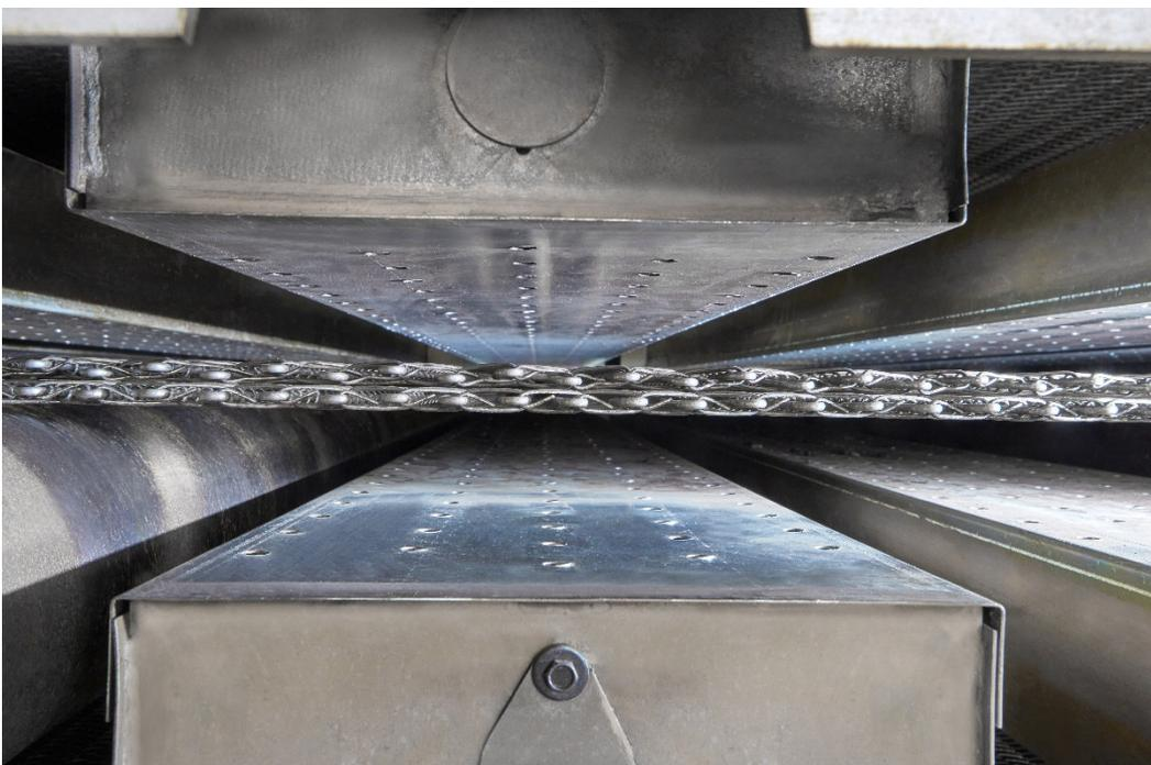
Durch Trag- und Deckband sowie durch die spezielle Sinus-Methode wird das feuchte, zur Welligkeit neigende Furnierblatt im wahrsten Sinne des Wortes glatt durch den Trockner geführt. Bei Rollentrocknern oder Bandtrocknern ohne Sinus-Führung kommt es zum Teil zu sogenannten Omega-Trockenfurnieren, also ausgebeulten Elementen. Dies blockiert den Furnierdurchlauf.
