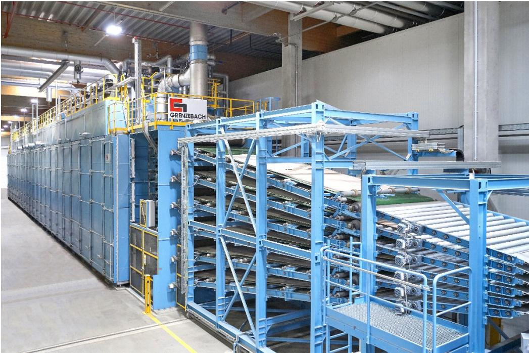
Das Furnier mit einer Faserlänge von 2.100 mm und einer Faserbreite von 2.200 mm muss im Bereich der Beschickung verlässlich zugeführt werden, der Transport durch den Trockner muss störungsfrei erfolgen und es muss zu einem sauberen Austrag aus dem Trockner kommen.
