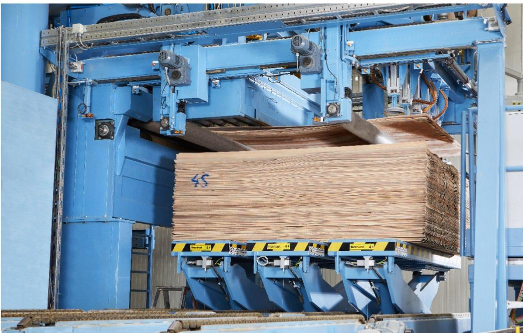
Die geschälten, feuchten Einzelfurnierblätter werden im Beschickssystem durch einen intelligenten asymmetrischen, vakuum-unterstützten Anhebe-Prozess dem Trockner zugeführt. Eine ungewollte Doppellagenbeschickung wird dadurch vermieden. Die Einzelfurnierblattabnahme nach Zuführung eines neuen Stapels erfolgt übergangslos, was für höchste Effizienz sorgt. Zusätzlich trägt der integrierte Holzstaub- und Partikelabscheider für eine reduzierte Staubkonzentration in der Halle bei.
