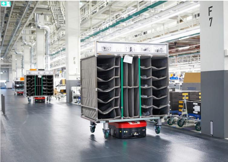
Das Fahrerlose Transportsystem L1200S von Grenzebach transportiert bis 1,2 Tonnen längs oder quer - und kann zudem auf der Stelle drehen. Dank sehr niedriger Bauhöhe kann das L1200S jeden Lastenträger (Tische, Trolleys, Gestelle, Regale) unterfahren, diesen anheben und zum vorgegebenen Zielort transportieren.
