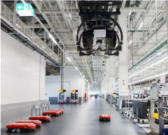
Das Fahrerlose Transportfahrzeug L1200S im Einsatz bei der Produktion des neuen Audi A8 in Neckarsulm. Das L1200S transportiert bis 1,2 Tonnen längs oder quer - und kann zudem auf der Stelle drehen. Dank sehr niedriger Bauhöhe kann das L1200S jeden Lastenträger (Tische, Trolleys, Gestelle, Regale) unterfahren, diesen anheben und zum vorgegebenen Zielort transportieren.
