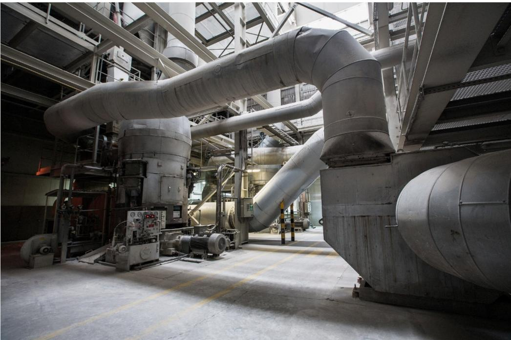
*Durch den Einsatz eines 3D-Scanners können die Grenzebach Experten vorhandene Anlagenkomponenten exakt erfassen und die neue Stromtrocknungsanlage einfach und schnell in die bestehende Kalzinierung integrieren.*
