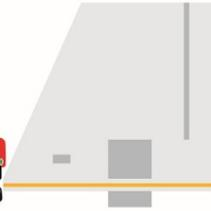
Bislang tastete das Fahrerlose Transportfahrzeug (FTF) den Boden in Fußhöhe nach Hindernissen ab. Das neue System erfasst einen größeren Bereich und nimmt auch Objekte wahr, die der Sensor in Fußhöhe nicht erkennen kann.
