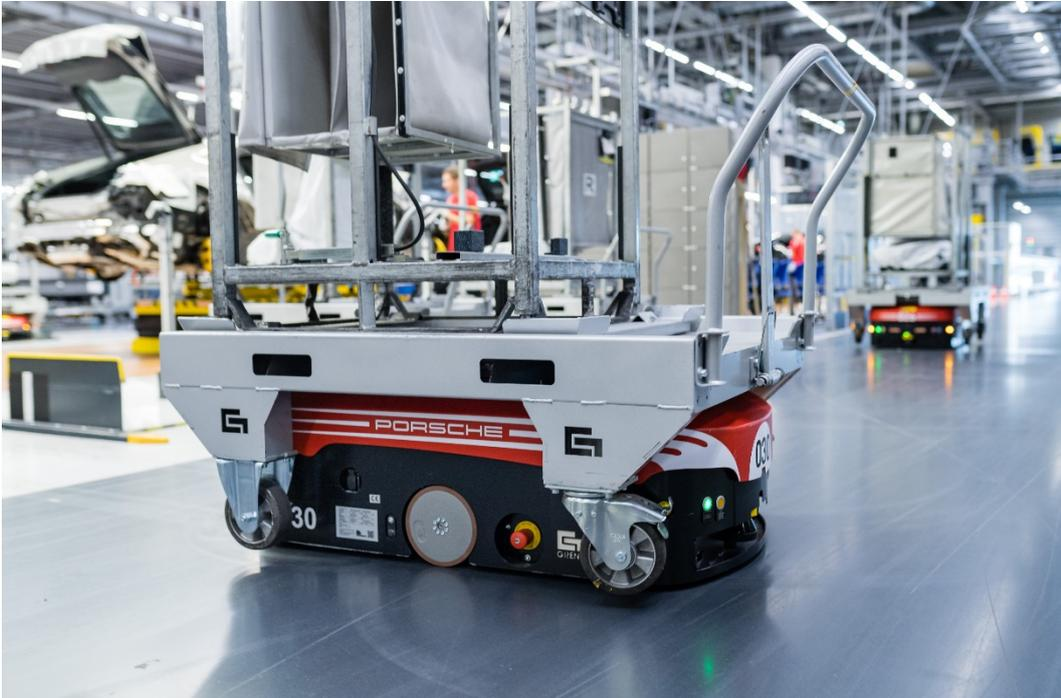
Bild 02: Die Grenzbach Warenträger wurden so angepasst, dass die Ladungsträger des Zulieferers beibehalten werden konnten.
