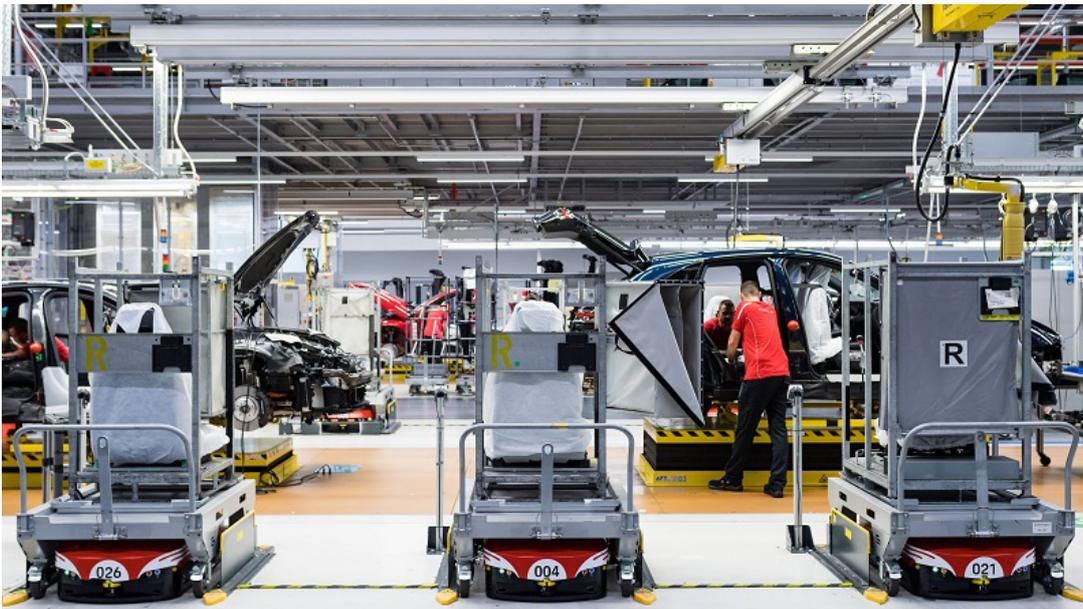
Bild 01: Grenzbach L1200S FTS stellen an drei Anstellpositionen Just-in-Sequence und hochpräzise Sitze für den Einbau in die Sportwagen zur Verfügung.
