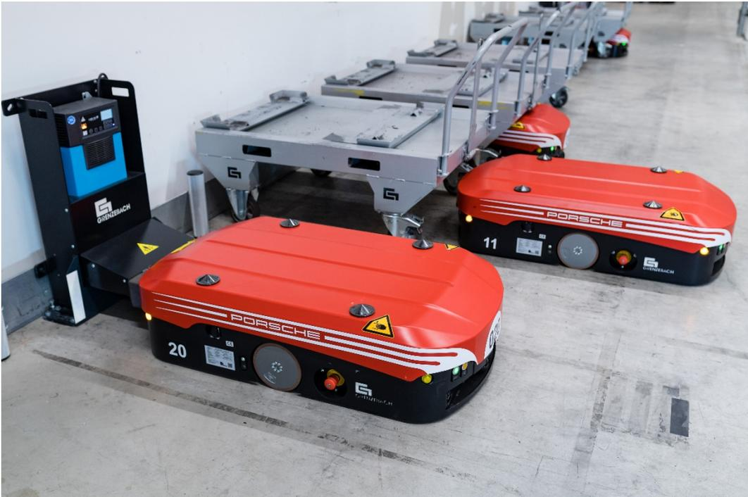
Bild 03: Moderne Lithium-Ionen Batterietechnik sorgt für kurze Ladezeit und maximale Verfügbarkeit der Grenzebach L1200S.
