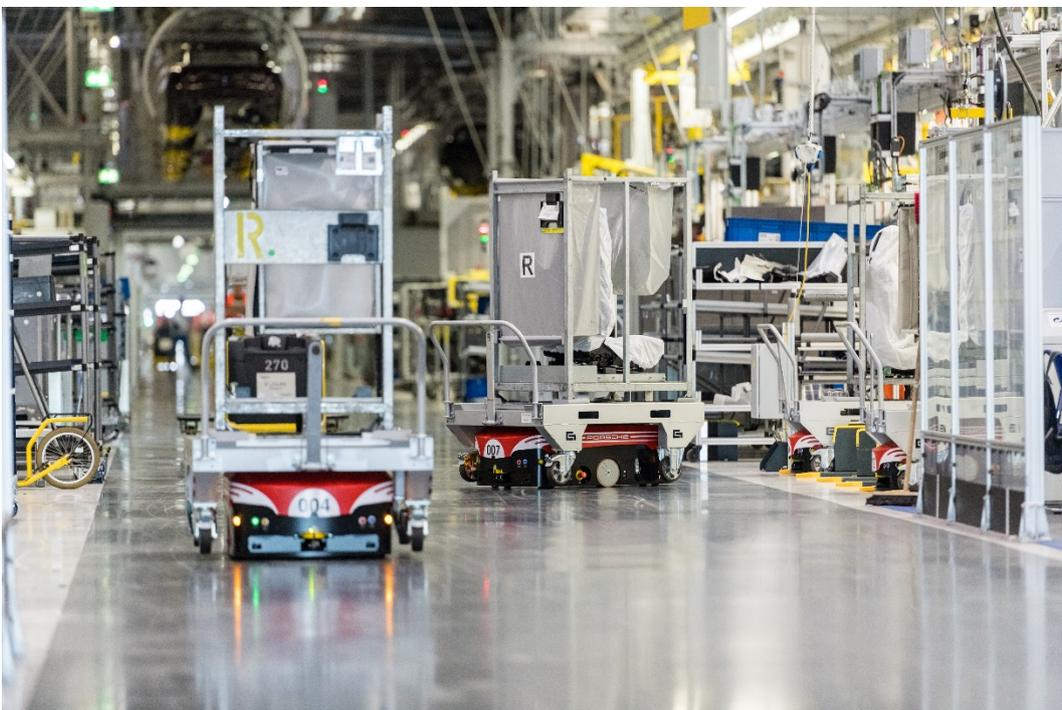
Bild 05: Im Gegensatz zu den bisher eingesetzten, manuellen Routenzügen kann beim Automatisierten Teiletransport mit Fahrerlosen Transportsystemen flexibel auf Sequenzänderungen reagiert werden.
