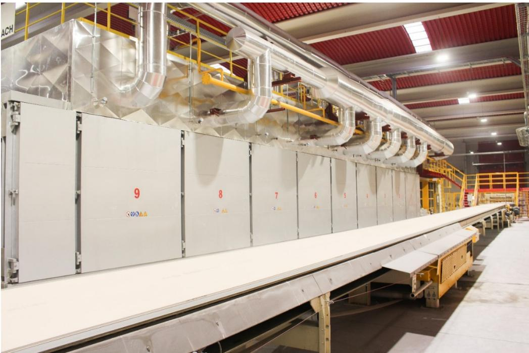
Der Trockner im Fokus: Die intelligente Trocknersteuerung sorgt für maximale Energieeffizienz und hält die Emissionen auf niedrigem Niveau.
