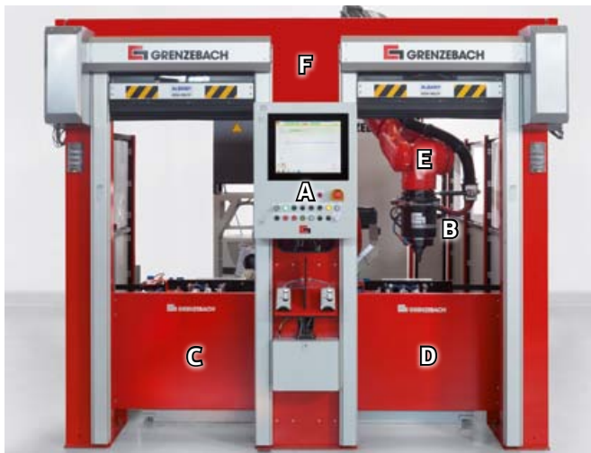
A) HMI / Prozess- & Systemsteuerung B) FSW-Schweißkopf mit Reibwerkzeug C) Schweißstation 1 D) Schweißstation 2 E) Roboter/Führungsmaschine F) Sicherheitseinhausung mit autom. Rolltoren
