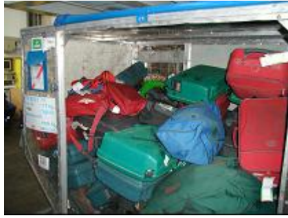
Abbildung 3: Beispiel eines Flugzeugcontainers für den Transport von Stückgut bzw. Gepäckstücken.
