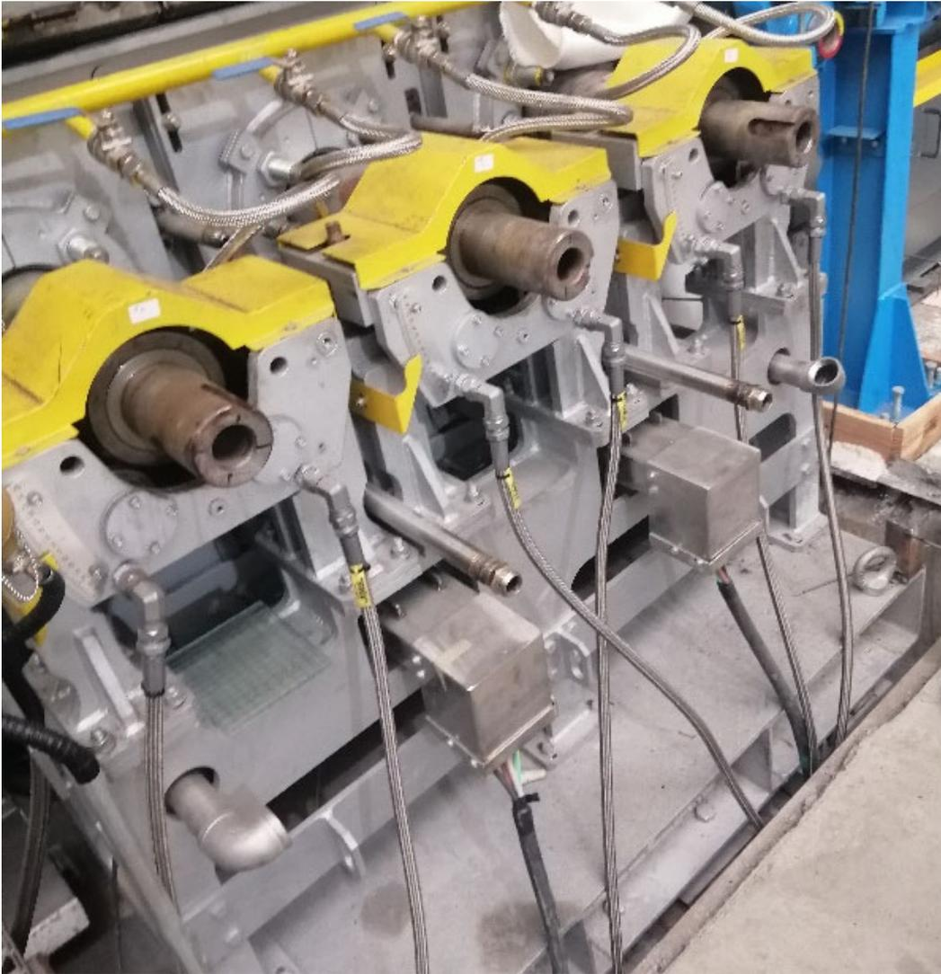
*Die Drossbox: Hier wird das auf dem Zinn schwimmende, vorgefestigte und geformte Glas erstmals von drei motorisierten Rollen herausgehoben und an den Kühlöfen übergeben.*
