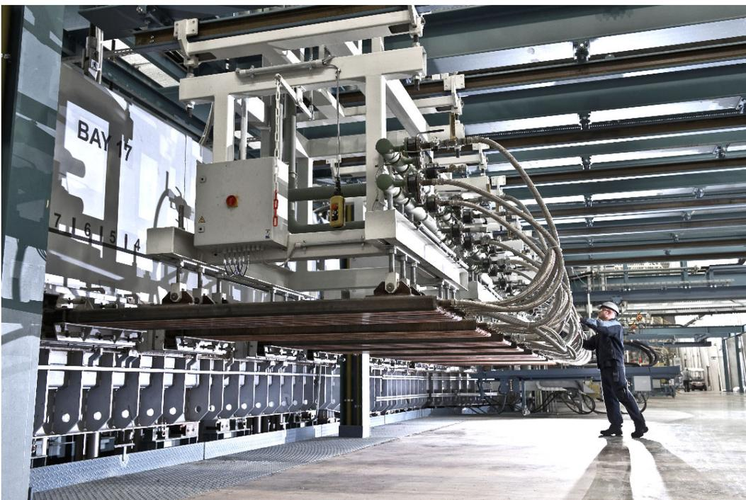
CNUD EFCO GFT liefert das komplette Zinnbad mit allem, was dazu gehört. Neben Design und Konstruktion ist es auch die intelligente Zusammenstellung für einen optimalen Anlagenbetrieb entscheidend. Alle Komponenten werden im eigenen Haus gefertigt: das Zinnbad mit seinem hochkomplexen Equipment, die Top-Roller und die Drossbox.
